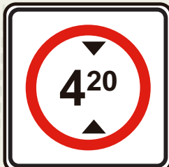
Altura libre restringida
