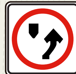
Indica el inicio con tramo con camellón
